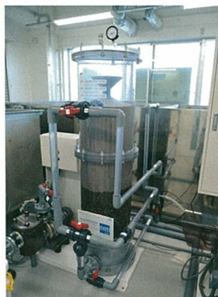
透明なる過装置を使って、ろ過と逆洗のしくみを観察できる。
